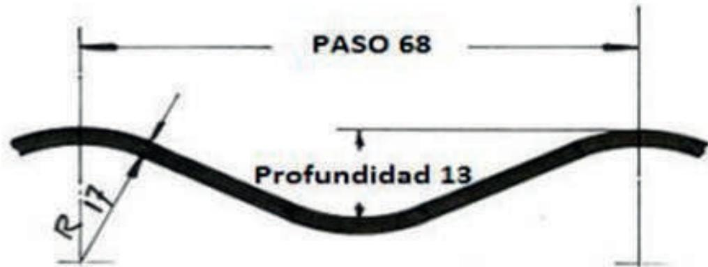
**Figura 1. Dimensiones de la corruga 68 mm x 13 mm**
